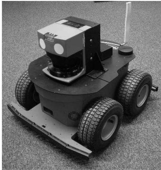
Abbildung 4.1: Der Roboter (Pioneer2 AT von ActivMedia) ausgestattet mit einem SICK-Laserscanner.
