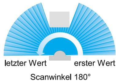
Abbildung 3.2: Drehrichtung des Scanners LMS 200.
