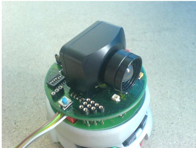
Abbildung 4.9: Der Turm mit der *CMUCam2* auf dem Khepera II.
