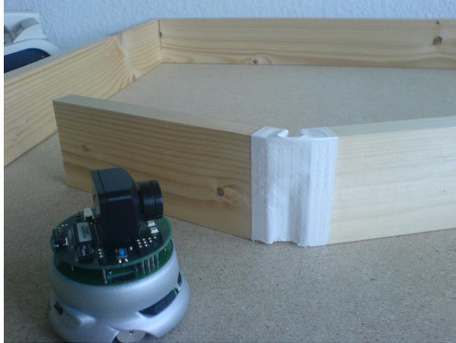
Abbildung 4.2: *Die Realisierung von nicht-rechtwinkligen Hindernissen. Der Spalt zwischen den beiden Holzstücken wird mit Textilband verklebt, so dass sich für die Distanzsensoren des Khepera keine Spalten zeigen. Der Khepera hier ist mit der Kamera ausgestattet. Sie wird in Kapitel 4.3.1 genauer beschrieben.*
